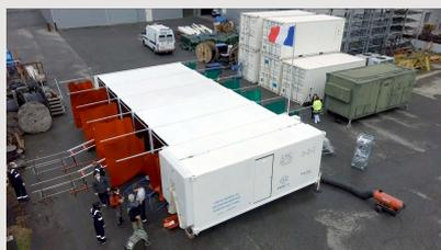
Le shelter multi déployable est replié dans un unique container ISO 20 pieds, aérotransportable et embarqué sur un seul camion. L'UMD offre 8 couloirs de décontamination (dont 2 pour patients sur brancards). Capable de traiter 80 victimes par heure l'UMD répond au besoin de gestion de situations médicales exceptionnelles avec de nombreuses victimes. Le déploiement au plus près de la zone sinistrée permet d'épargner l'infrastructure hospitalière et de réduire les transports médicalisés.
