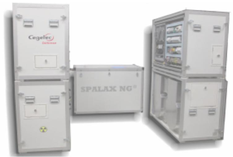
Le Système de Prélèvement Automatique en Ligne avec l'Analyse du Xénon (SPALAX-NG) s'inscrit dans le réseau international de surveillance pour la mise en oeuvre du traité d'interdiction des essais nucléaires de l'OTICE (CTBTO).
