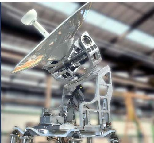
Cegelec Défense ACCIS met en œuvre un savoir-faire stratégique dans la réalisation de positionneurs d'antennes, de tourelles et de plateformes stabilisées et de pointage.
