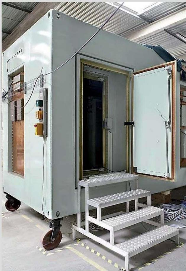
باعتبارها مكوناً رئيسياً للشبكات تحت الأرض أو مراكز التشغيل الموجودة في مبنى فوق الأرض، تؤدي أقفاص فاراداي دوراً حيوياً لمنع تعرض النظم للخطر، والحماية ضد النبض الكهرومغناطيسي عالي الارتفاع، وحماية أمن الاتصالات و"تيمبست".
